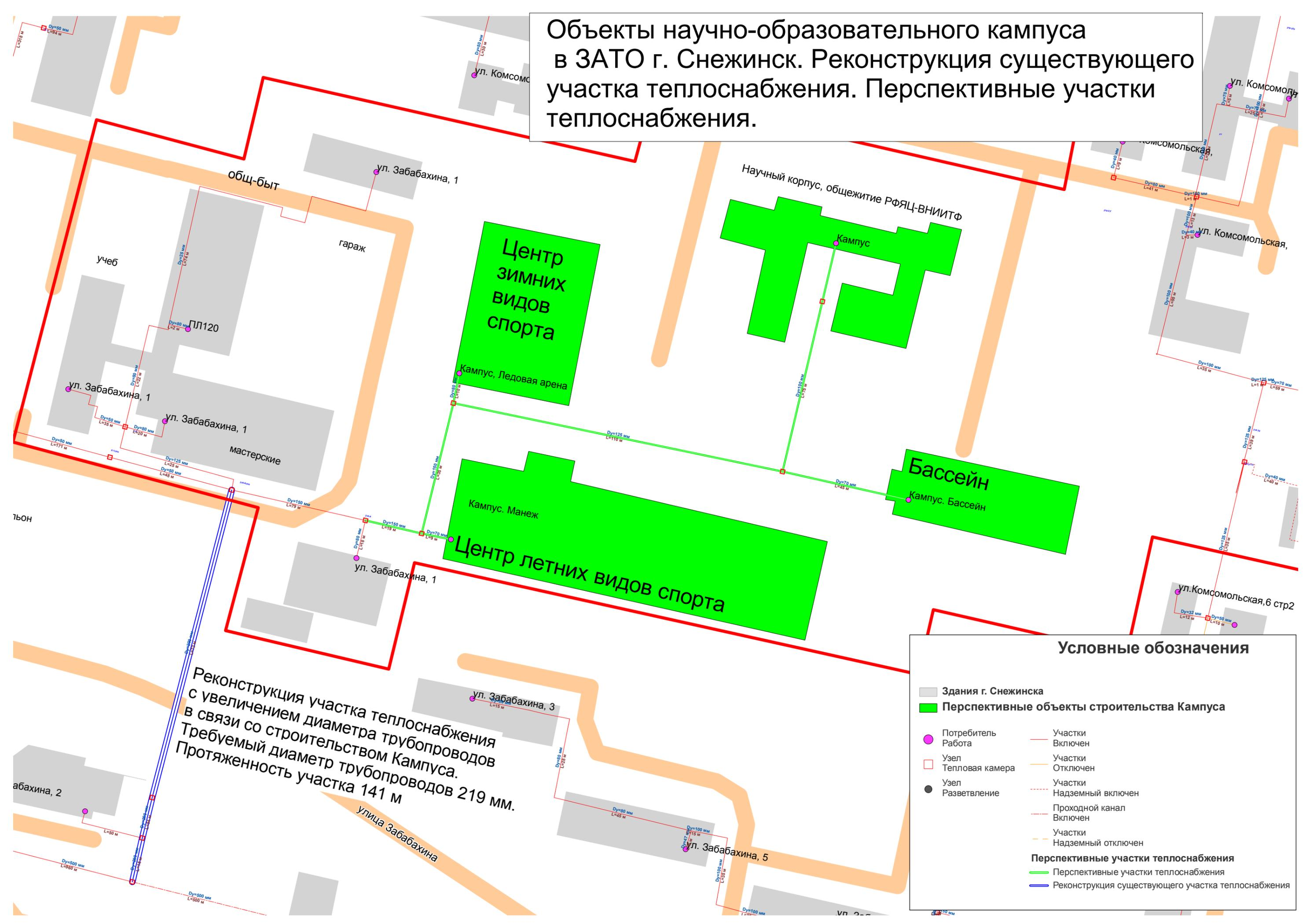
Реконструкция участка теплоснабжения с увеличением диаметра трубопроводов в связи со строительством Кампуса. Требуемый диаметр трубопроводов 219 мм. Протяженность участка 141 м
